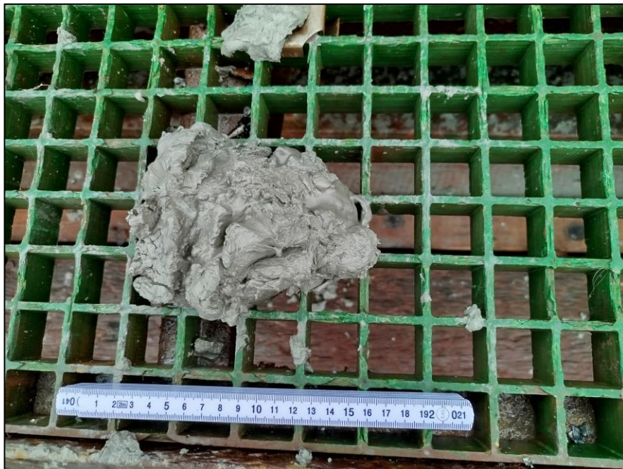
Figura 15. Particolare del sedimento argilloso a circa -15 m
